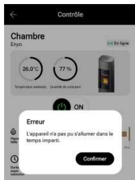
Fig. 15.2 Message indiquant l'impossibilité d'allumer le feu en raison d'un niveau de combustible trop bas
