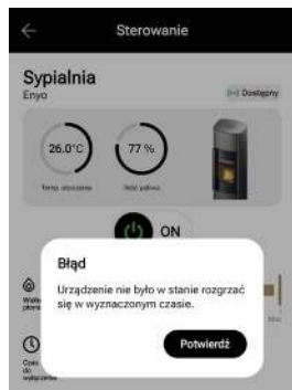
Rys. 15.4 Komunikat o nieprawidłowym rozgrzaniu urządzenia
