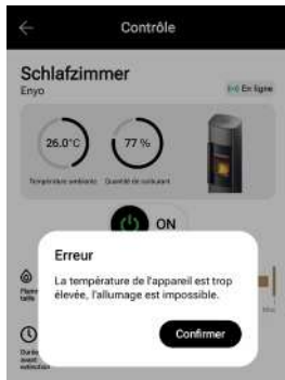
Abb. 15.1 Meldung über die Unmöglichkeit, ein Feuer zu zünden, weil die Temperatur des Geräts zu hoch ist
