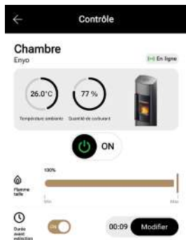
Fig. 11.3 Cheminée fonctionnant à pleine puissance et s'éteignant au bout de 9 minutes
