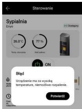
Rys. 15.1 Komunikat o braku możliwości rozpalania przez zbyt wysoką temperaturę urządzenia
