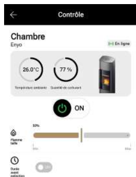
Fig. 10.6 Cheminée fonctionnant à 50 % de sa puissance maximale
