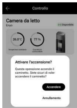
Fig. 10.2 Schermata di conferma in cui si chiede all'utente se desidera accendere il caminetto
