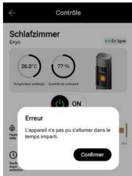
Abb. 15.2 Meldung, dass das Feuer aufgrund eines unzureichenden Brennstoffstands nicht entzündet werden kann
