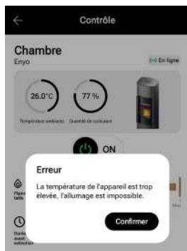
Fig. 15.1 Message indiquant que l'allumage est impossible en raison d'une température trop élevée de l'appareil
