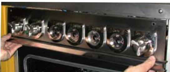
5. Déplacer prudemment le panneau de commande de sa position et l'appuyer sur la porte du four ouverte
