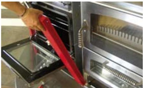
8. Monter la façade en l'appuyant du bas en haut et en vissant les vis dans leur position originale.
