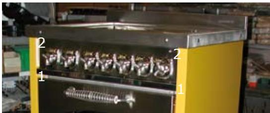
3. Desserrer les deux vis se trouvant sous le pli du panneau de commande
