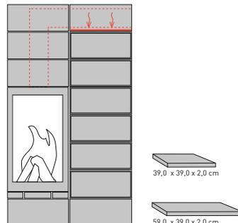
S'il est prévu de placer un élément avec conduit de fumées intégré au-dessus ou sur le côté du compartiment-four ou du compartiment de rangement, il est principalement nécessaire d'insérer une plaque réfractaire faisant écran à la transmission de chaleur vers l'élément juxtaposé.
