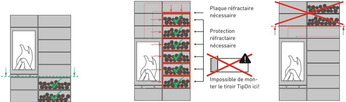
L'élément est situé au-dessous en partie latérale de la chambre de combustion. Dans cette situation, le transfert de chaleur est insignifiant. Il est également possible d'équiper cet élément d'un portillon de fermeture.
