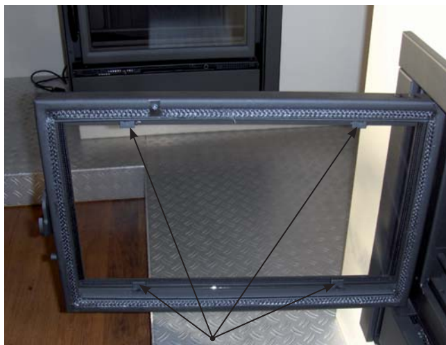
Figure 5: Remplacement de la vitre de la porte
