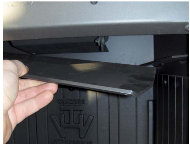
Figure 3 Pose du déflecteur des gaz de fumées dans le poêle
