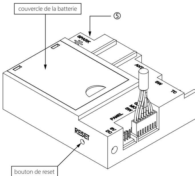
Si les piles sont plates ou le récepteur est défectueux, il est possible de commander l'appareil à la main. Pour ce faire, il faut d'abord débrancher le câble (piézo) du récepteur et le glisser avec précaution au raccordement piézo du bloc de réglage du gaz.
