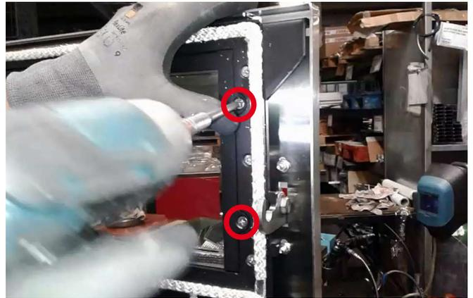
Retirer les deux supports métalliques à la base de la vitre en desserrant les vis qui fixent la vitre à la porte. Il est maintenant possible de retirer la vitre interne et de nettoyer entre les deux vitres.
